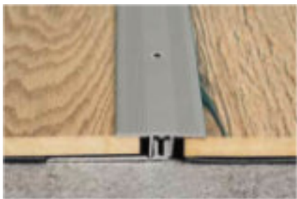
Prechodové profily, 34 mm pre podlahy hrúbky 6,5 až 16 mm
