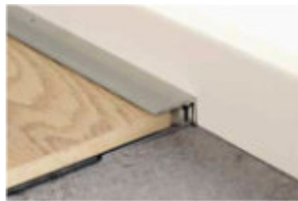
Ukončovacie profily, 21 mm pre podlahy hrúbky 6,5 až 16 mm
