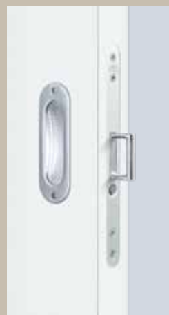
Pomocou zaskakovacieho madla môžete krídlo dverí prebiehajúce v stene kompletne zasunúť do steny. Stlačením gombíka madlo vyskočí a Vy môžete zatvoriť dvere.
